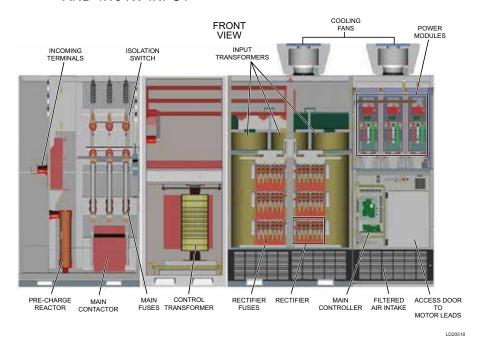
FIGURE 12 - TYPICAL OPTISPEED HIGH-VOLTAGE DRIVE FROM 6.6 KV TO 13.8 KV INPUT
