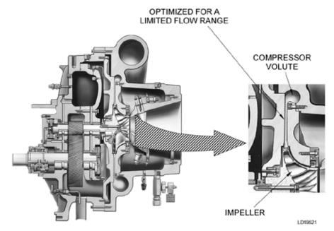
FIGURE 6 - TYPICAL CENTRIFUGAL COMPRESSOR
