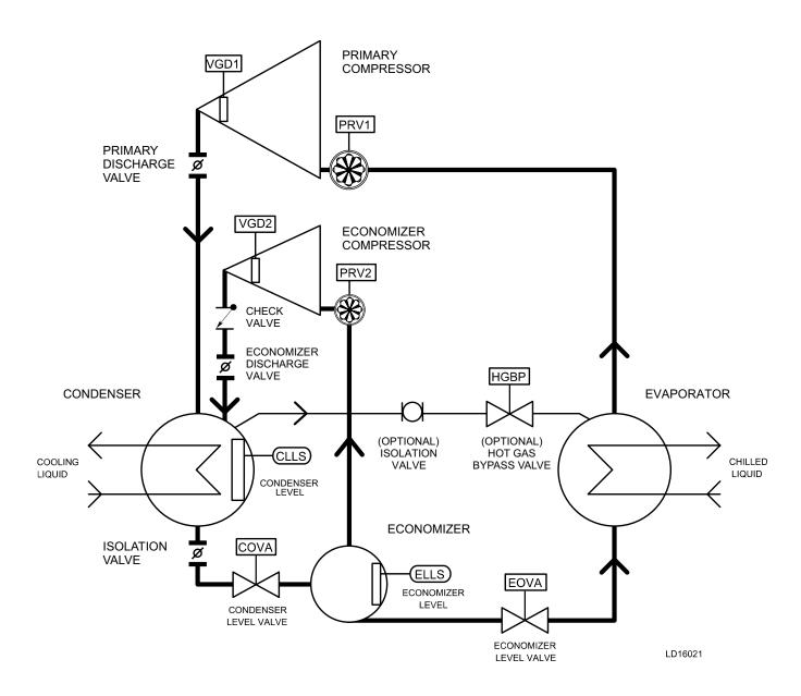
FIGURE 8 - REFRIGERANT INSTRUMENTATION DIAGRAM
